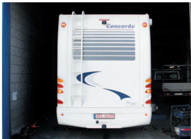
Der Rollen-Prüfstand ist unbestechlich: Die neuen Leistungsdaten werden überprüft.
