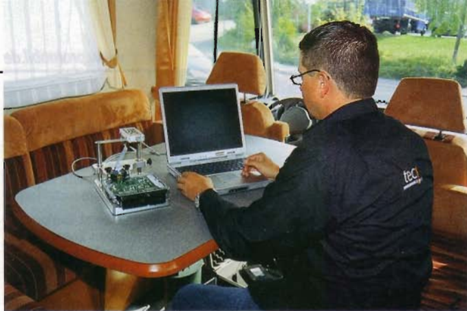
Die Motorsteuerung wird mit einem Spezialgerät umprogrammiert.
